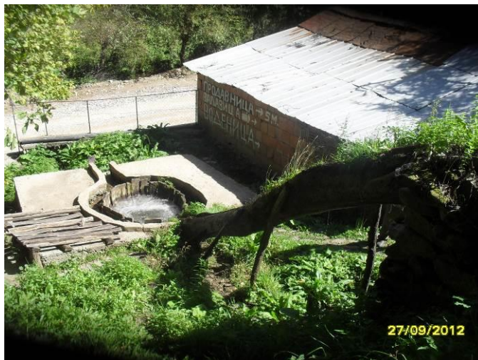
Фотографија бр. 15. Водена валавица – вир (кош) со букова коруба , за валање јамболлии и килими, с. Станци
