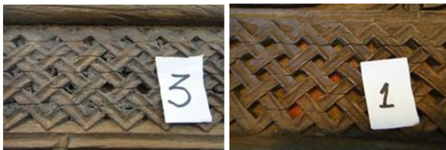
Сл. 5: а) примерок за анализа на исполната поставена меѓу резбаните полиња б) изглед на резбата по чистењето и на црвената боја во основата (извор: од личната колекција на авторот, 6.10.2016 година)
